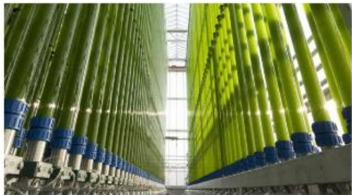
buborékoszlopos reaktor - AG ecoduna, Austria
