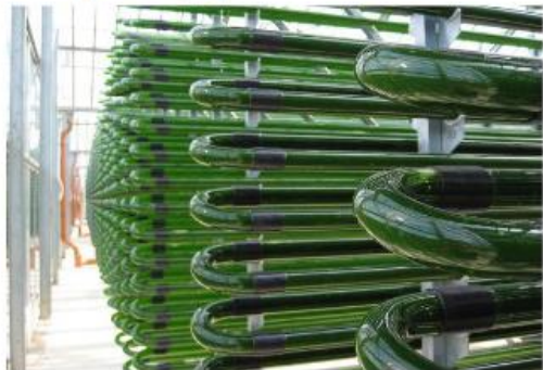
buborékoszlopos reaktor - Clearas Inc., USA
